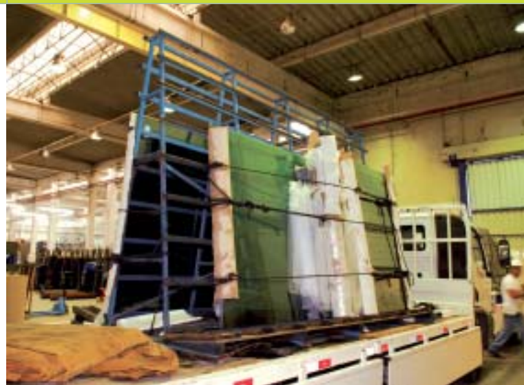
Cavalete instalado e fixado em caminhão com carroceria aberta
