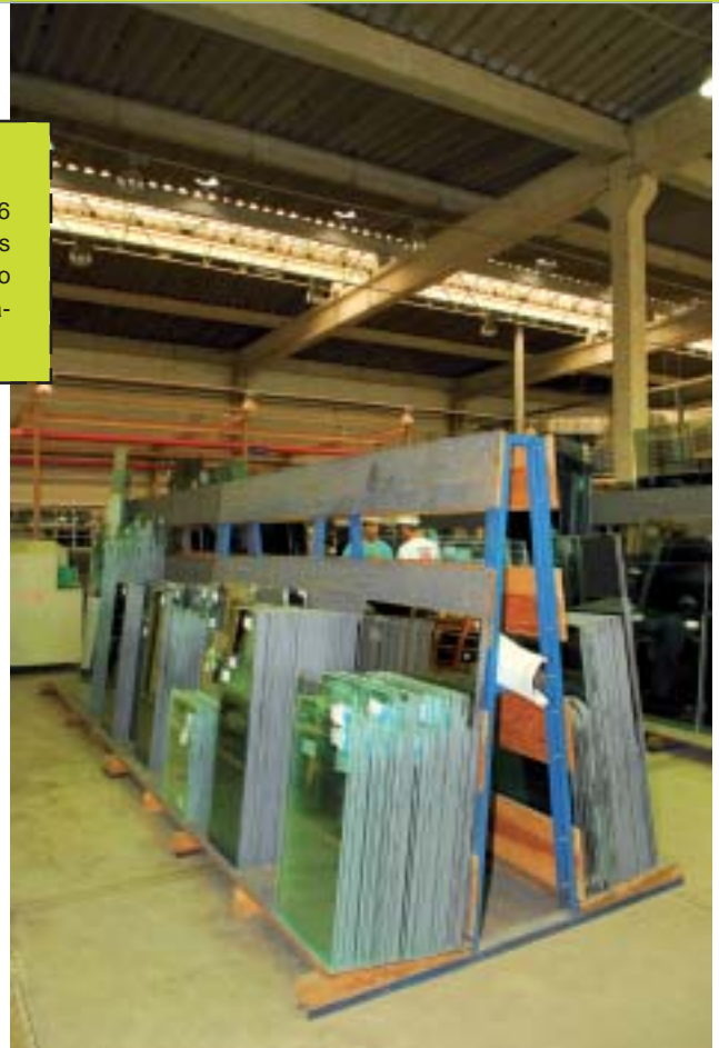
Cavaletes para armazenamento temporário, dentro da transformadora
