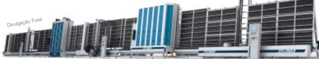
Forel: linha automática para fabricação do vidro duplo
