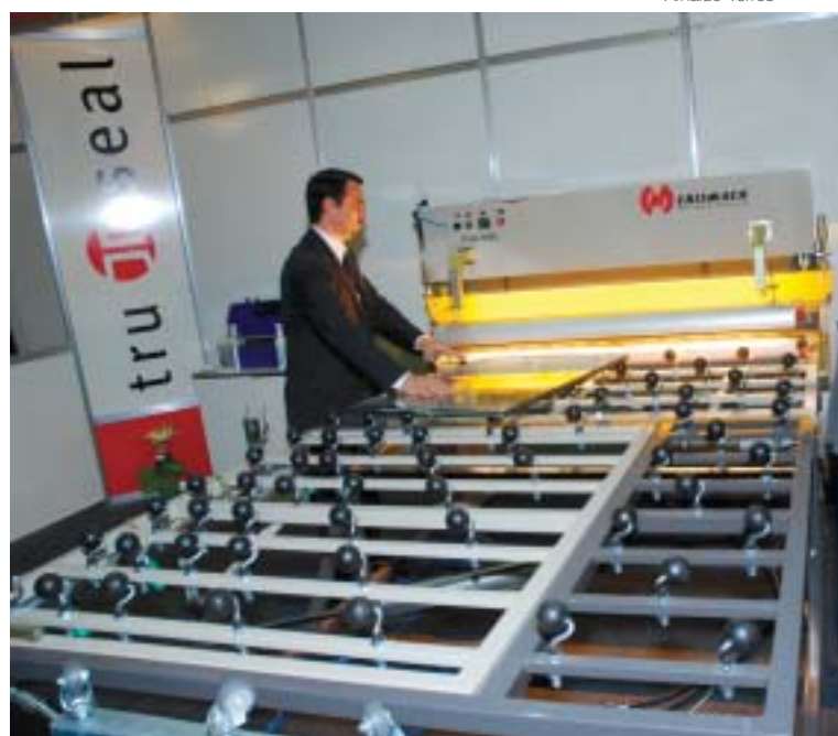
Crismach: máquina para fabricação do vidro duplo
